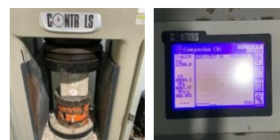
Gambar 4. Pengujian kuat tekan bata ringan CLC
