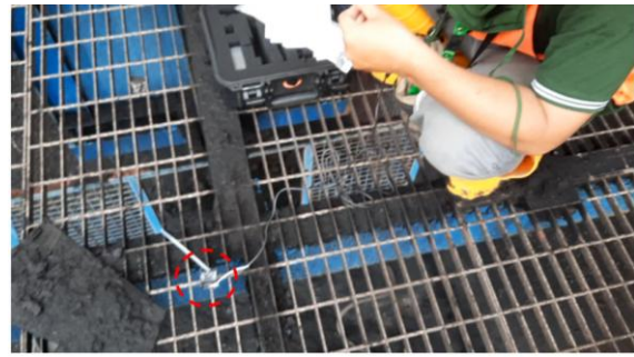
Gambar 2. Pemasangan accelerometer kabel diletakkan pada lantai pelat baja (grated steel slab).
